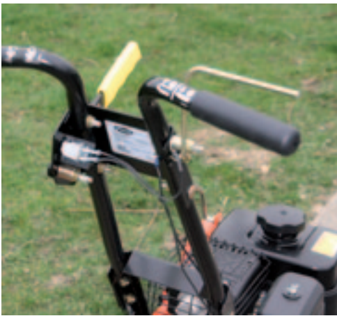
Bij de Ariens blijft de motor draaien als je de duwboom loslaat.
