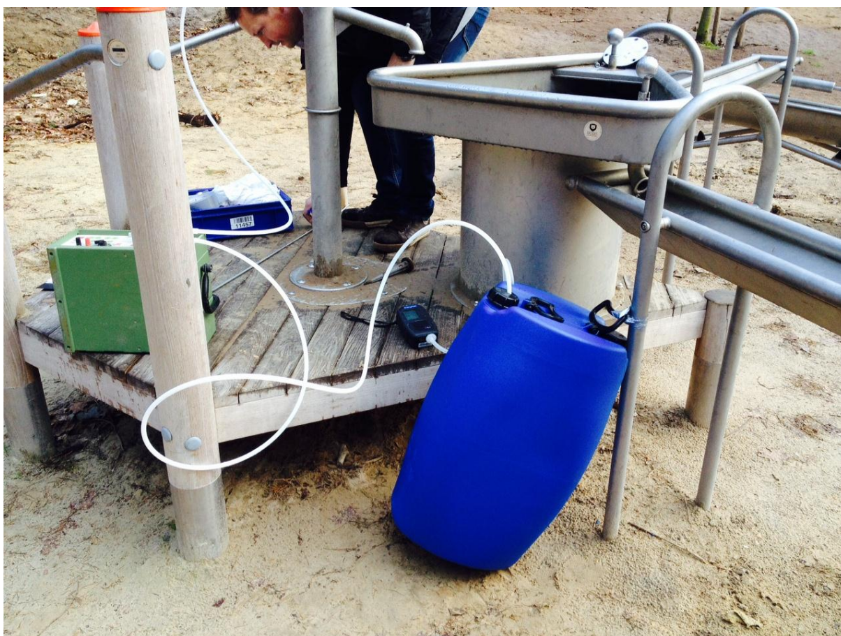
Foto 4.1 Meetopstelling H 2 S bij metalen speeltoestel Zandbos 8 april 2014 (Locatie A).
