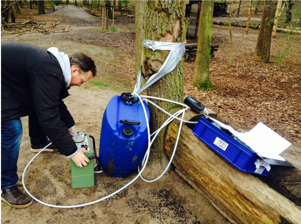
Foto 4.2 Meetopstelling H 2 S bij boomstampomp Zandbos 8 april 2014 (locatie 2).
