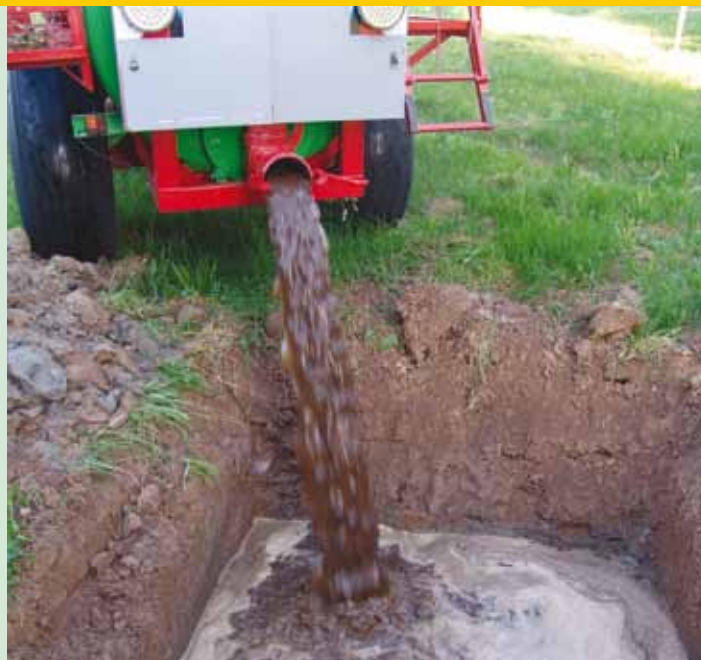
Storten in water opgezogen materiaal.
