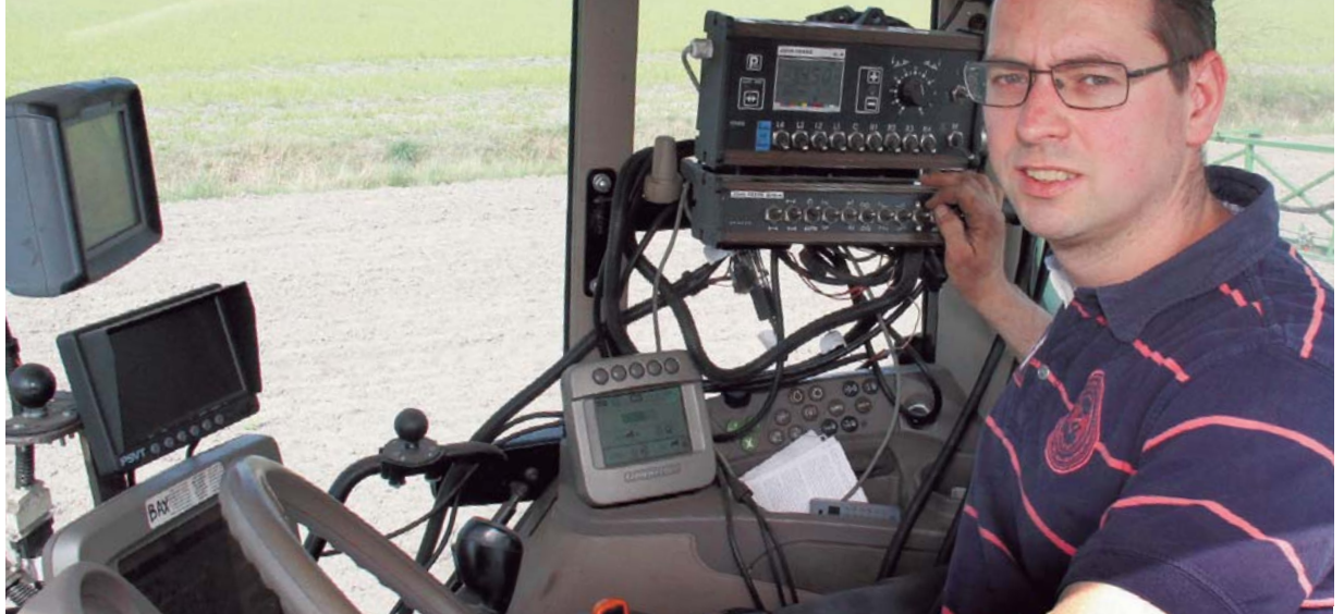
De Yara N-sensor zit op de cabine van de trekker en meet tijdens het spuiten met vier 'ogen' de hoeveelheid biomassa in het gewas, in banen van 3 meter aan weerszijden van de trekker.
