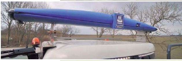
De Yara N-sensor zit op de cabine van de trekker en meet tijdens het spuiten met vier 'ogen' de hoeveelheid biomassa in het gewas, in banen van 3 meter aan weerszijden van de trekker.
