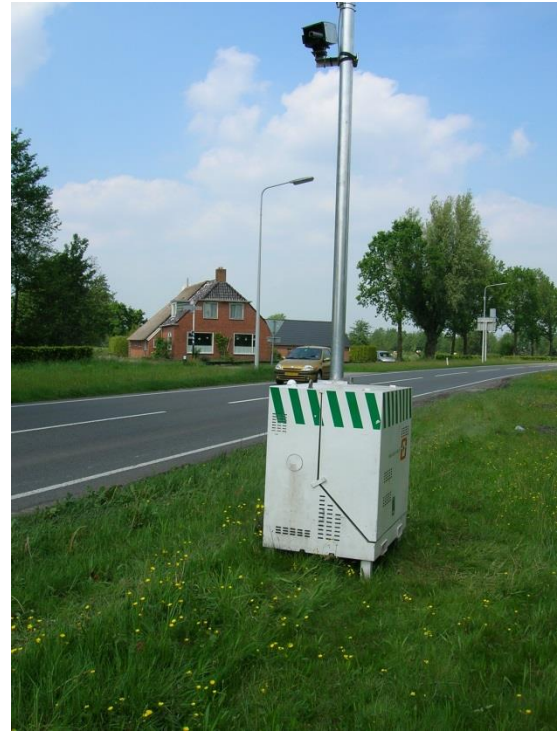
Figuur 17. Tijdelijke meetapparatuur voor landbouwverkeer op de N358 bij Surhuisterveen (mei 2011)
