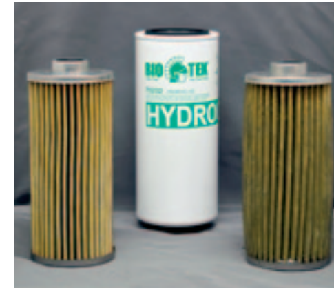
^ Het Bio-Tek-filter van Cim-Tek Links een nog ongebruikt Bio-tek-filter-element. Het element rechts is gebruikt en verzadigd met water.
