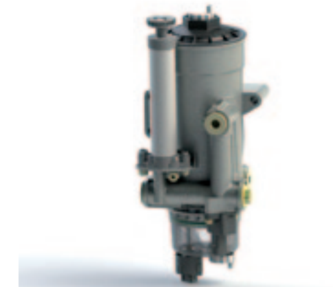
^ Apart filter Het HDP-filter van Hydac komt in het vacuüm-gedeelte van het brandstofsysteem, voor de opvoerpomp en het reguliere filter dus.
