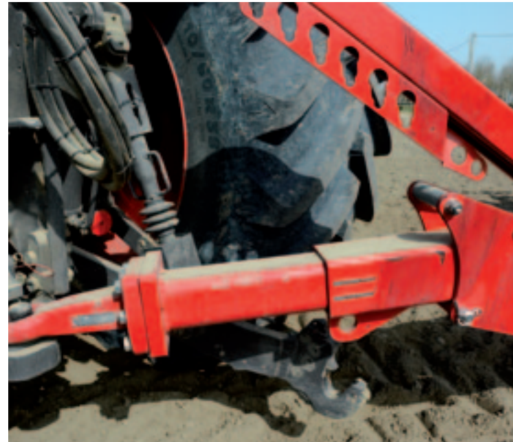
^ Verstelbare dissel De dissel is in lengte verstelbaar. Het is verstandig om de sneleg in de onderste hefarmen van de trekker hangen. Dat laatste voorkomt dat de trekkerbanden de dissel raken bij scherp draaien.
