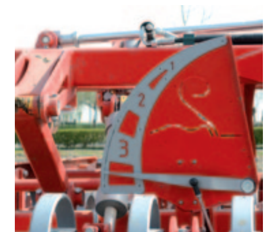
^ Positie koppensneler De koppensneler, de voorste egaliseringsbalk, is hydraulisch in te stellen. De exacte diepte wordt met een wijzer aangegeven.
