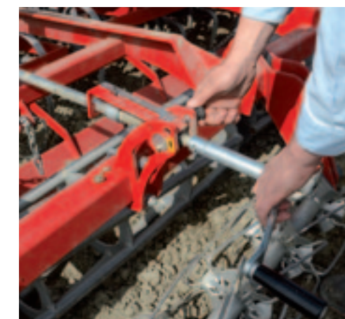
^ Spindel De werkdiepte van ieder tandenveld ten opzichte van de voorste en achterste rol verstel je handmatig met een spindel.
