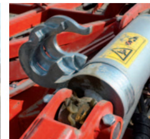
^ Opvulling kop Door vulringen tussen de aanslag en de hydraulische cilinder te draaien stel je de machine horizontaal af.
