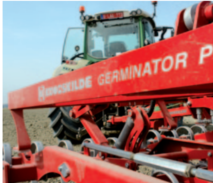
^ Zwaarder frame De Germinator Pro is voorzien van een verzaard frame. Dat moet zijdelingse krachten beter kunnen opvangen. Met name bij het keren op de kopakker treden die op. Zeker als er een flinke trekker voor staat.
