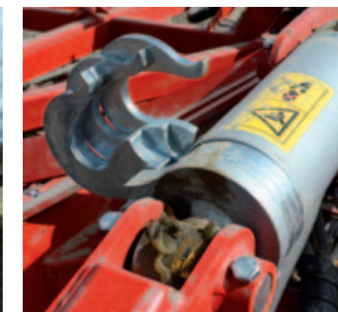
^ Opvulling kop Door vulringen tussen de aanslag en de hydraulische cilinder te draaien stel je de machine horizontaal af.
