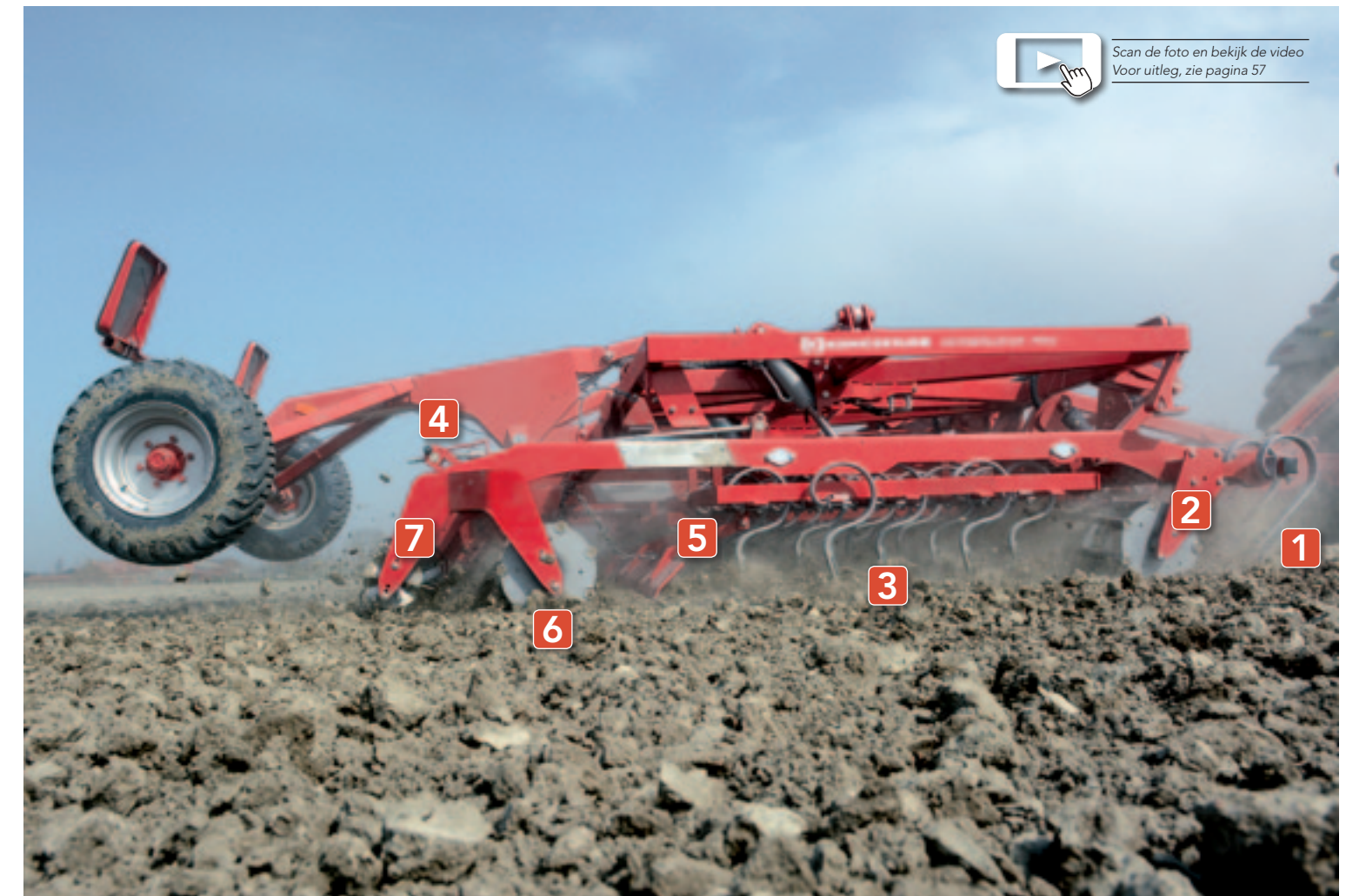
^ De zes bewerkingen van de Germinator Pro Vooran de Germinator Pro zijn egaliserende peddels geplaatst [1] die de koppen van de ploegvoren halen. Daarachter volgt de voorste aandrukrol; een open kooirol [2] die de grond ook verkruiemt. Vijf rijen tanden [3] verkruiemen en mengen de grond nog meer. De diepte stel je met een spindel [4] in. Daarna volgt een egaliseringsbord [5] en een tweede aandrukrol [6]. Als laatste is er een verkruiemende en verdichtende rotocraat-rol [7].
