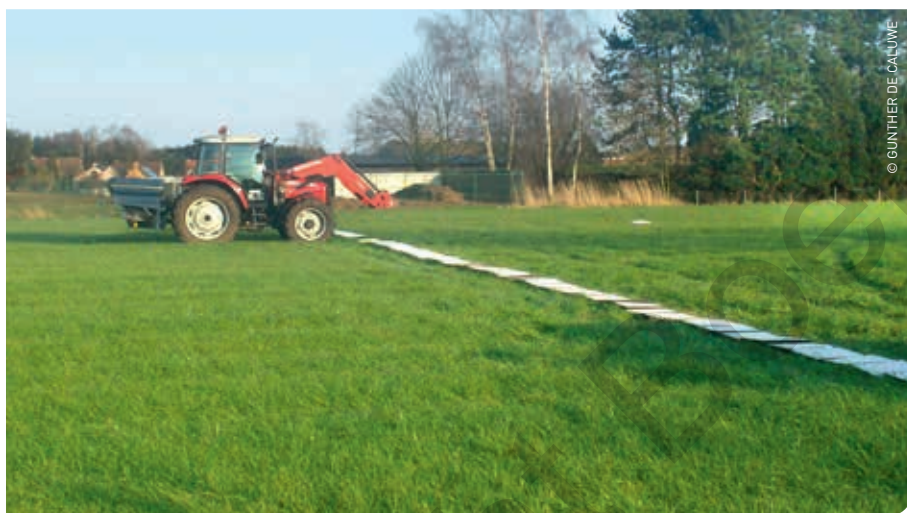
Opmeten van het transvers strooibeeld via collectiebakken.
