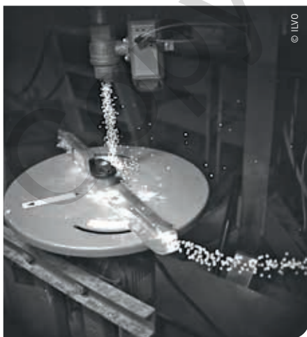
Figuur 2 High speed beeld van korrels die een strooischijf verlaten.
