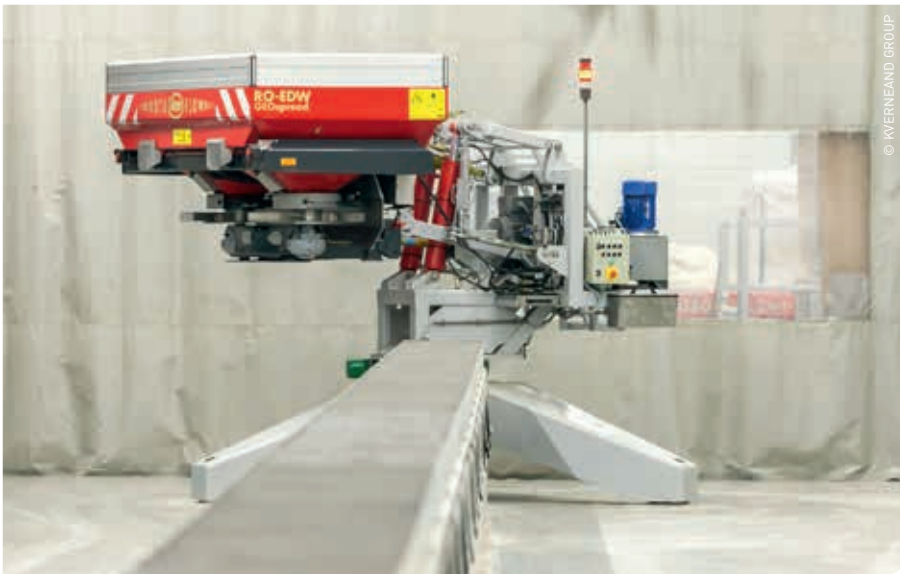
Radiale testopstelling om het 2D-strooibeeld op te meten.
