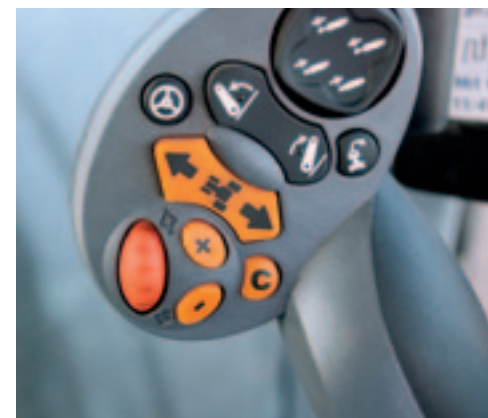
Joystick Met de joystick stuur je de transmissie, de hef en de hydrauliekcilinders aan. Alle 'rijknoppen' zijn oranje, de rest is zwart.
