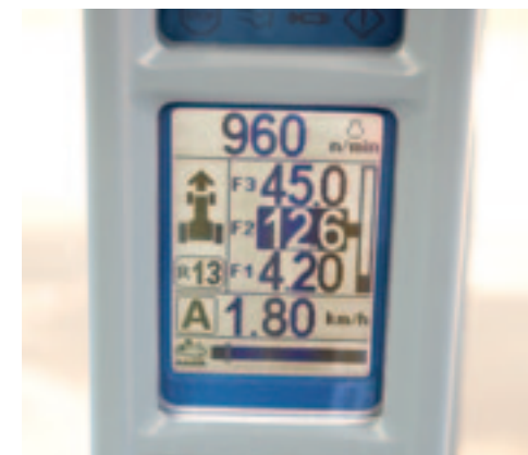
Maximale rijnsnelheden In de rechter A-stijl van de cabine zijn de drie doelsnelheden af te lezen die de chauffeur zelf kan instellen op de joystick.
