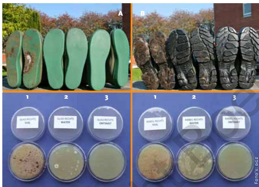
Laarzen met gladde zolen (A) of profielzolen (B) die respectievelijk ongereinigd (1), gereinigd met water en borstel (2) en ook ontsmet (3) werden na rondgang in een varkensstal. Op de bijhorende voedingsbodem is de respectievelijke kiemgroei te zien.
