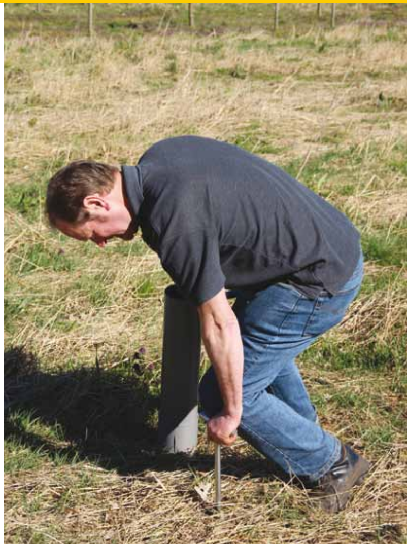
De standaardmonsterdiepte is 25 cm. Bij een storende laag kan daarvan afgeweken worden.
