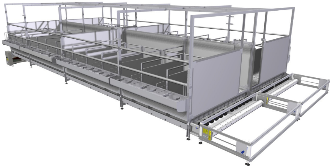
Figuur 5 V-vormige mestband voor de gescheiden afvoer van mest en urine bij vleeskalveren.
