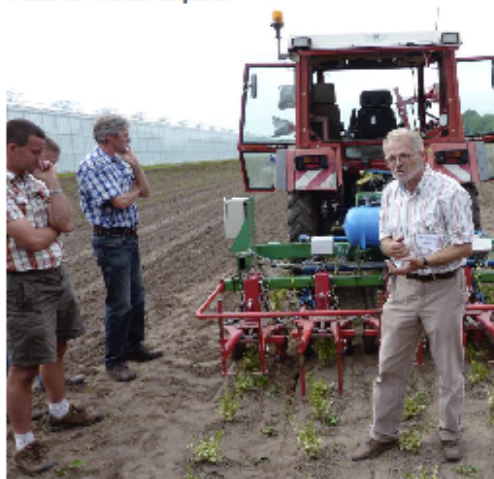
Figuur 2. Demonstratie van de intra row weeder met buxus.
