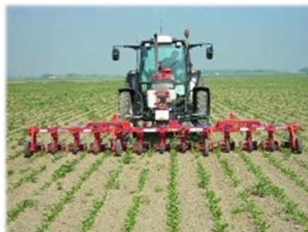
Fig. 5. Schijfvernevelaar, onkruidbestrijding tussen de rij.
