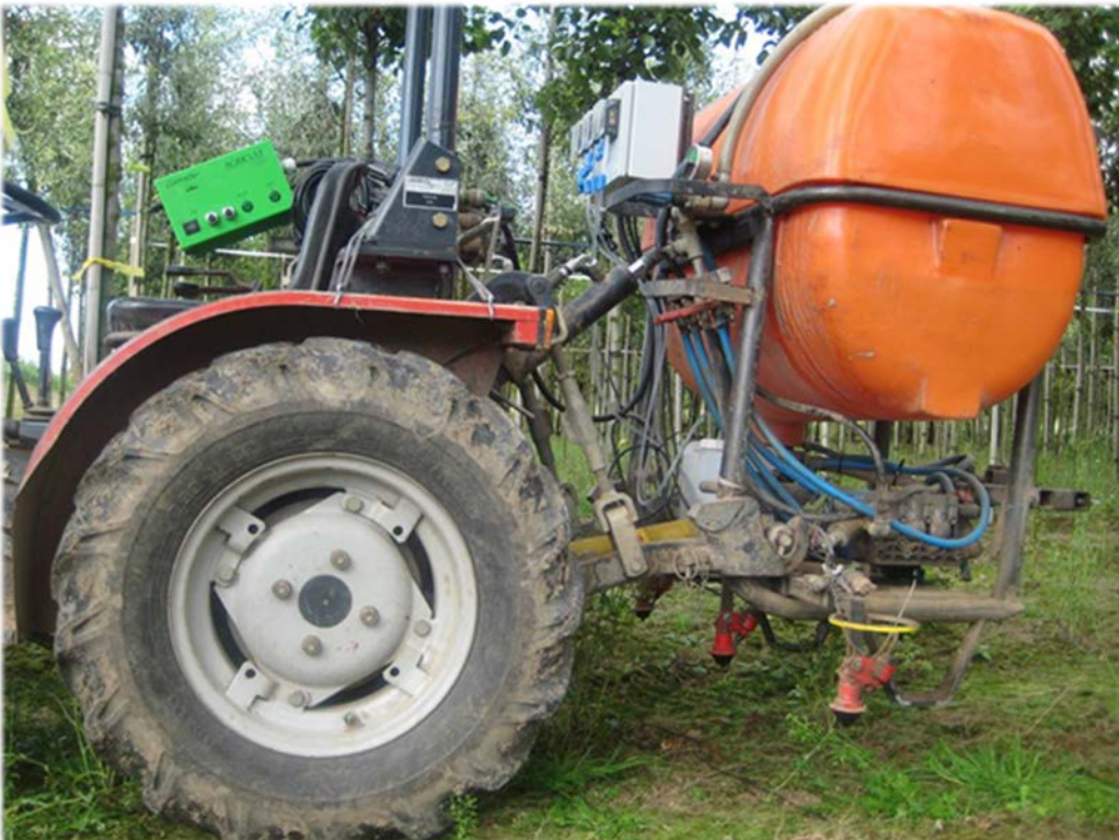
Figuur 7. Agricult Laag Volume Spuit (LVS). Deze tussen-de-rij-techniek vindt al toepassing in de boomkwekerij en is perspectiefvol voor een forse verlaging van het middelengebruik.
