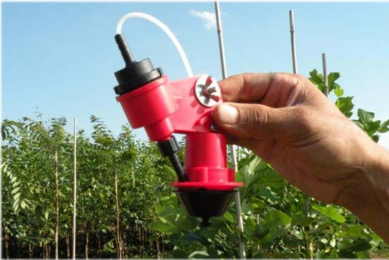
Figuur 6. Schijfvernevelaar in detail.
