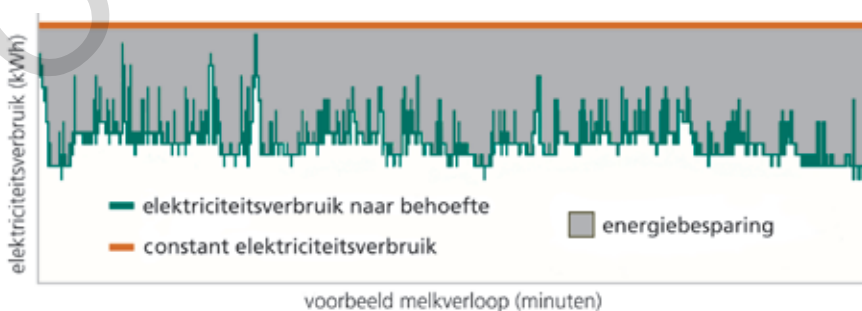
Figuur 3 Verbruik van een frequentieregelaar - (Bron: v0D EnergySaver - GEA Farm Technologies Belgium)
