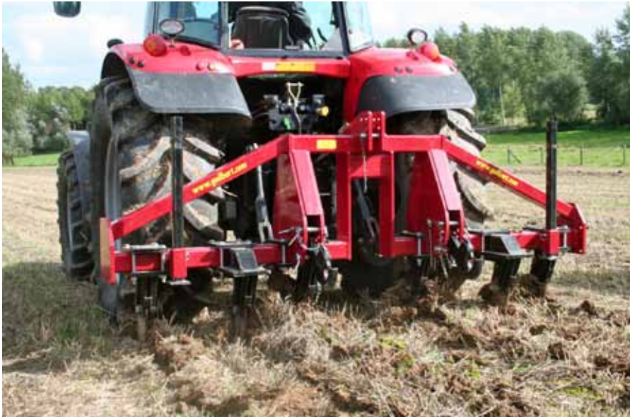
De Guilbart Combi 600-12-decompactator licht de grond op zodat die in stukken breekt.
