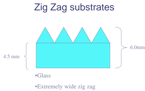
Fig. 28a: Afmetingen van het glas substraat met een zigzag vorm aan de bovenzijde
