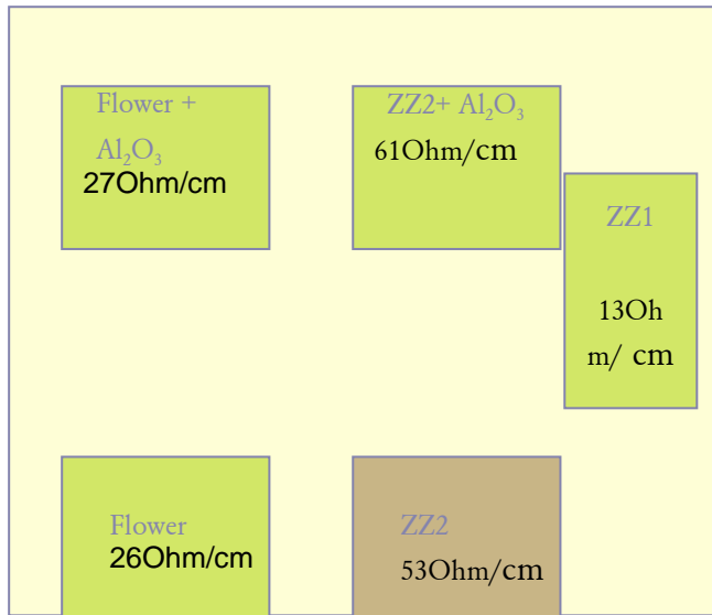
Fig. 35 Plaatsing van de verschillende micro-V substraten in het sputter systeem met bijbehorende sheet weerstanden voor 800 nm dit ITO.
