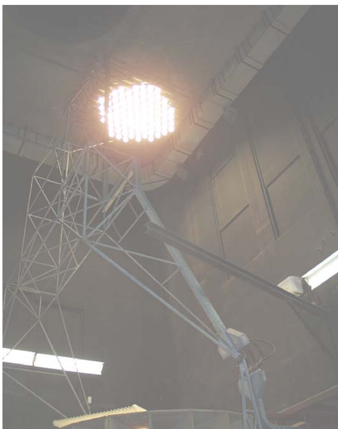
Fig 26. Testopstelling met hoekafhankelijke halogeenverlichting van 13,5 KW. (Voormalige IMAG locatie Mansholtlaan 10-12)
