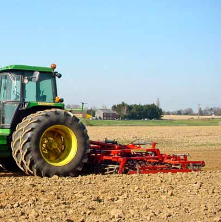
Gecombineerd werktuig voor het klaarleggen van het zaaibed met gebruik van dubbelluchtbanden.
