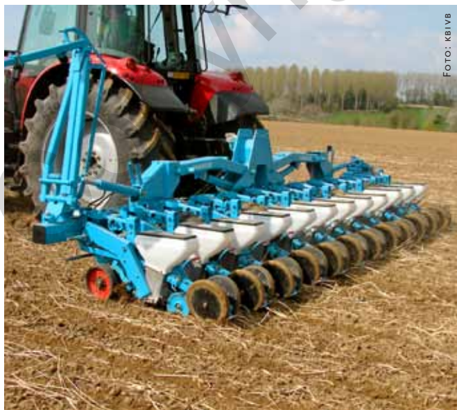
Specifieke zaaimachine voor de directe zaai van suikerbieten in al dan niet ondergewerkte mulch.
