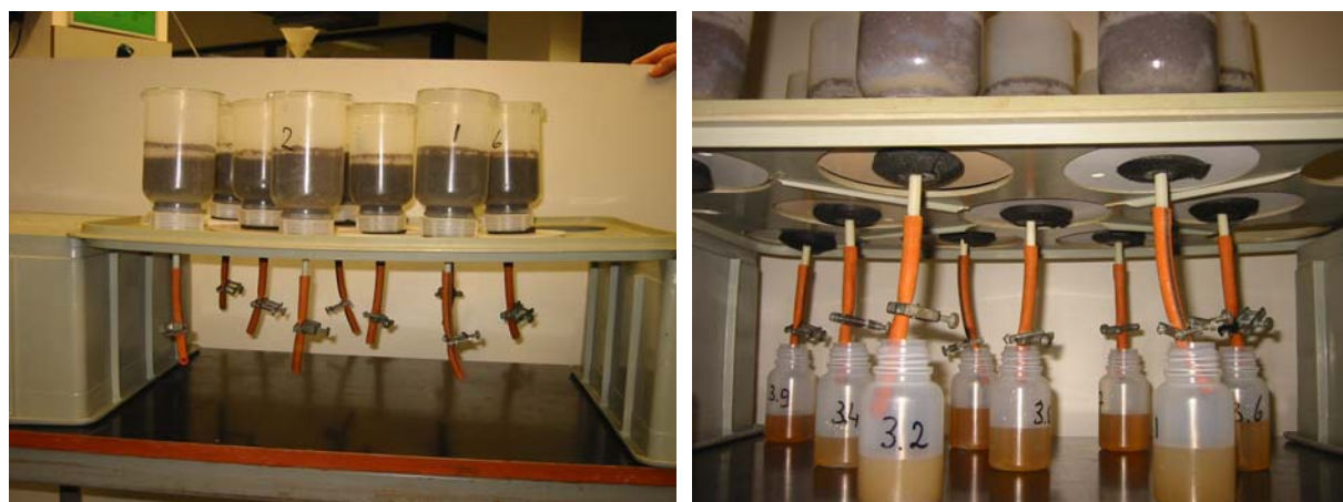
Fig. 6. Foto's van de opstelling van de uitspoelingsproef
