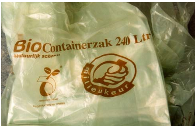
Containerzak voor GFT-container, gemaakt van een blend van zetmeel en synthetische composteerbare polyesters.
