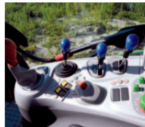
Deutz-Fahr geeft de bediening kleuren. Oranje voor de transmissie, blauw voor de hydrauliek, groen voor de hef en geel voor de aftakas.
