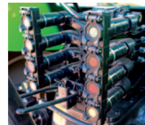
Vier dubbelwerkende ventielen met mechanische bediening inclusief kruishendel. De drukloze retour en volgwagenberemming zijn standaard.
