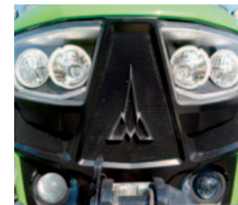
In de behuizing van de koplampen zitten stripjes met witte ledlampjes die overdag voor een subtiele oogopslag zorgen.
