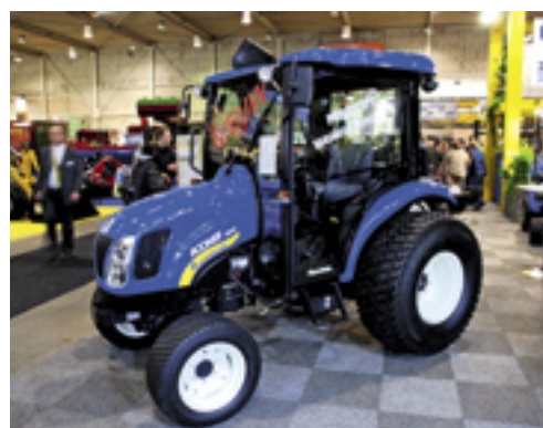
▲ New Holland toonde de Boomer 3045, een trekker die vooral voor de groensector en met name voor gebruik op golfbanen is bedoeld. Opvallend is de nieuwe versnellingsbak in de trekker: een continu variabele transmissie die volgens het trekbandprincipe werkt. Zo'n transmissie is al vaker terug te vinden in personenauto's en de Dafjes zijn de meest bekende zijn. De trekker heeft een vermogen van 33 kW (45 pk). De transmissie kan echter ook in trekkers tot een vermogen van maximaal 137 pk zijn werk doen. Het ligt dan ook voor de hand dat ook de trekkers uit de huidige T5000 serie straks met de transmissie uitgerust worden.
