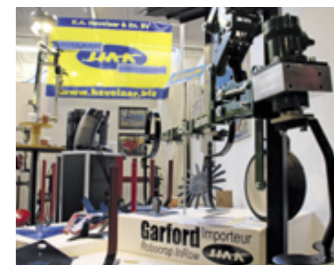
▲ Hak is sinds dit jaar importeur van het Engelse Garford, en dus ook van de Robocrop InRow schoffelmachine. De machine houdt met een camera per drie rijen in de gaten of in de rij cultuurplanten of onkruid staan. Een camera bekijkt 1,7 m 2 . Verwacht het systeem een plant, dan staat de schoffel stil. Verwacht hij geen plant, dan draait de schoffel razendsnel in de rij om zich meteen weer terug te trekken. Van tevoren moet je wel de plantafstand invoeren, maar de procescomputer houdt tijdens het werk ook de gemiddelde plantafstand bij. Een schoffelmachine met robotschoffels en gangbare schoffels kan volgens de fabrikant 98,5 procent van het veld schoffelen. Een vierrijige schoffelmachine kost 63.000 euro.
