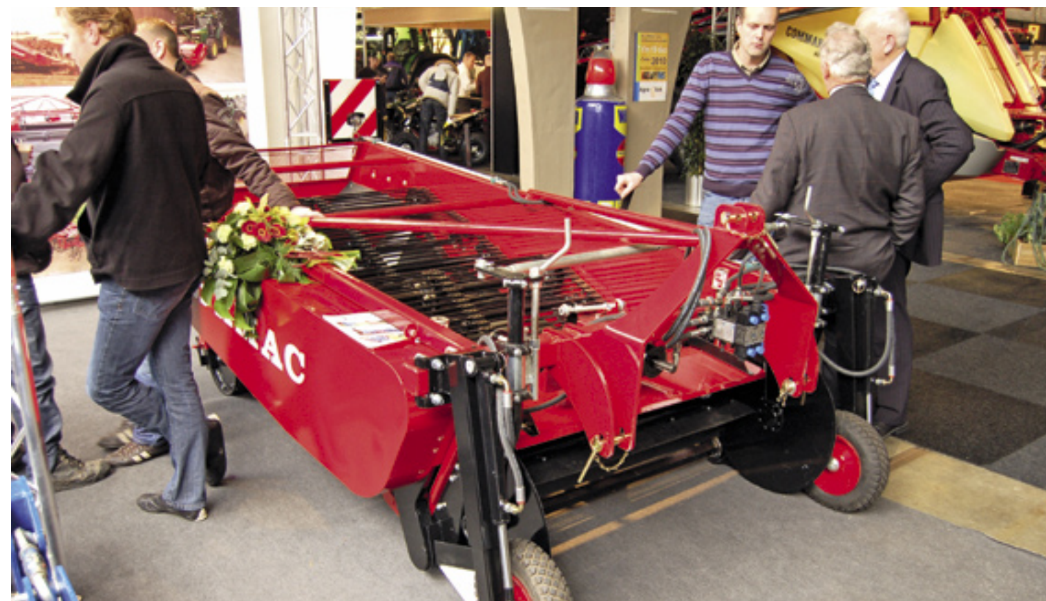
▲ VSS Agro toonde een verbeterde Amac uienrooier. Grootste verbetering aan de voorraadrooier betreft de rooias. Deze kreeg een betere lagering en een automatisch smeersysteem. De rooias is ook in oude typen te monteren. Achterop zit een voorraadbunker wat handig is bij draaien op de kopakker. Ook deze past op oudere typen. Optioneel is een automatische diepteregeling via tasters. De prijs is vanaf 10.000 euro.
