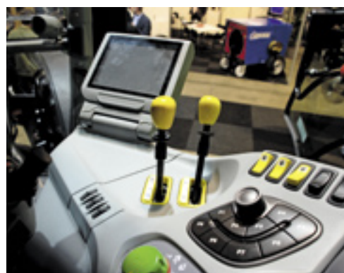
▲ Op de stand van Same Deutz-Fahr Holland pronkte niet alleen de met een traploze versnellingsbak uitgeruste Agrofarm TTV430, maar ook de eveneens traploze en 190 pk TTV 630. Hoewel nog geen enkele knop werkte en ook het scherm geen beeld vertoonde, toonde het interieur wel hoe de trekker binnenkort bediend wordt. In de rechterconsole bevindt zich namelijk een draaiknop en acht drukknoppen, waarmee je de belangrijke functies van de trekker en het kleine kleurenscherm bedient. Ook werktuigen die middels een isobus-stekker aan de trekker worden gekoppeld, zijn zo aan te sturen.
