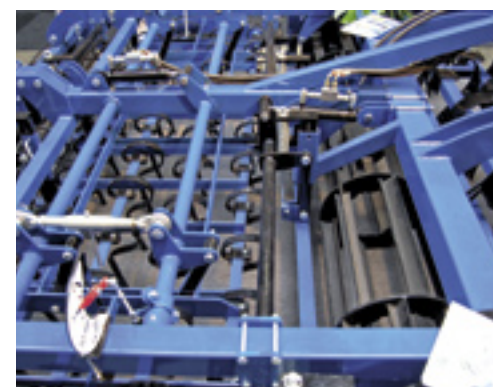
▲ Fabrikant VSS Agro uit Heinkenszand maakt inmiddels een hele lijn grondbewerkingsmachines. Op de stand was onder andere een nieuw zaaibereider te bewonderen. Nieuw aan deze modulaire gebouwde machine is de optionele hydraulisch centrale verstelling van de egalisatiebalk. De centrale verstelling is overigens ook handmatig uit te voeren. Tevens is de aanwijzing van de diepteregeling duidelijker gemaakt met een witte maan, zwarte cijfers en een grote rode wijzer.
