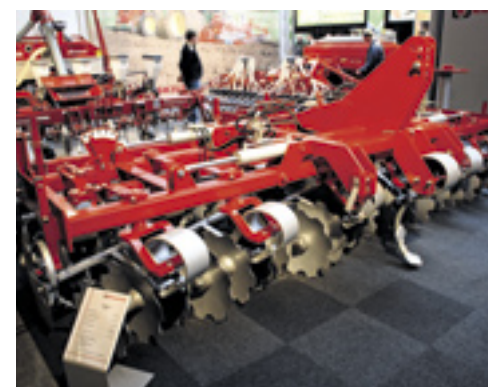
▲ De Terra D die Kongskilde liet zien in een werkbreedte van 4 meter, is voorzien van twee rijen verstelbare en geveerd opgehangen schijven. De werkhoeck is hydraulisch verstelbaar, ook tijdens het rijden. De wijzer geeft vervolgens de ingestelde hoek aan. Als optie levert de fabrikant een rij egalisatietanden maar ook een kooi- of pakkerrol. Naast een versie van 4 meter is de machine ook leverbaar met een breedte van 3 of 6 meter. De machines van 4 en 6 meter zijn hydraulisch opklapbaar. In de basisuitvoering, zonder rollen, kost de 2.400 kg wegende 4 meter brede Terra D 15.000 euro. De machine die op de AgroVak stond kost 21.000 euro.
