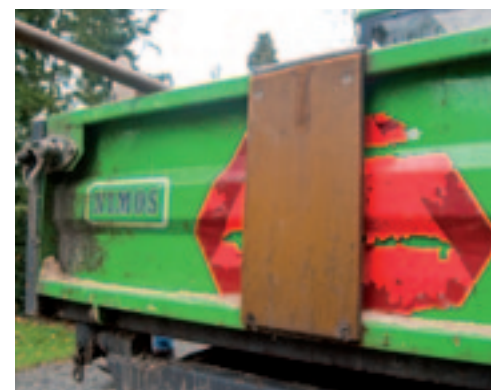
De klep van de bak verdraagt het treffen met de trekkogel slecht. Een 'eigen bouw'-oplossing.
