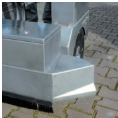
...en uitgeklaapt heeft de machine een werkbreedte van 1,10 m. In dat laatste geval zijn er vier verdelers actief. Ingeklapt zijn twee verdelers actief.
