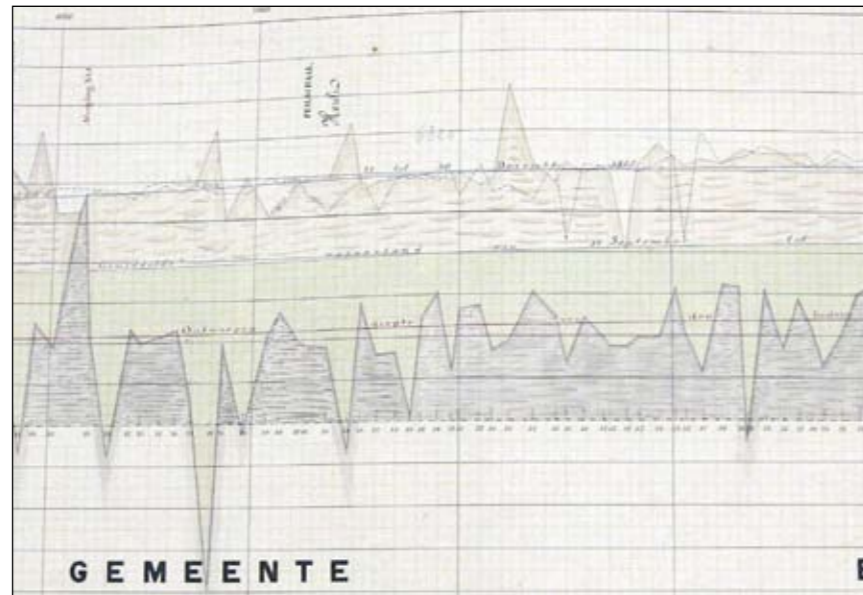
Kaarten uit het waterschapsarchieef 1863-1864, met links de legenda en rechts een gedeelte van de dwarsdoorsnede van de toenmalige bodemdiepte van de Dommel. Met een rode lijn is de 'nieuw' ontworpen bodemdiepte aangegeven.
