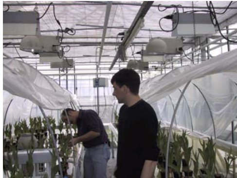
Figuur 4: Tunnel voor de toetsing van geïnduceerde resistentie bij tulp. Afgesloten compartimenten in een geconditioneerde kas met vernevelaars.
