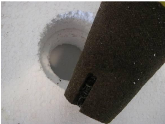
foto 38 Bovenaanzicht dikkere drijver: gerealiseerd door het op elkaar bevestigen van een 40 mm en een 60 mm dikke EPS-plaat. Op de voorgrond de in deze proef gebruikte Jiffypot
