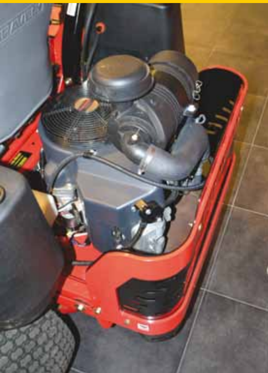
Trillingsdemping: motor in subframe, met rubberblokken aan hoofdframe.
