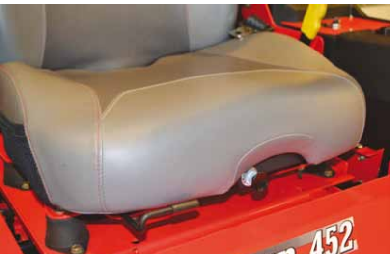
Trillingsdemping: Opblaasbare stoel op rubberblokken.
