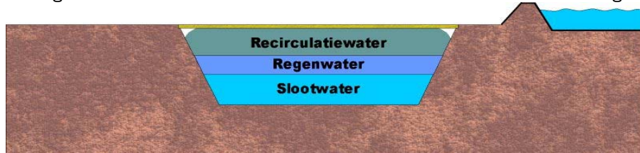
Figuur 3.18A Opslag van drie kwaliteiten water in Klimrek buffer (bron: Klimrek Buffer®)
