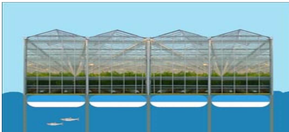
Figuur 3.14 Drijvende teeltvloer in bassin (bron: Klimrek Buffer®)
