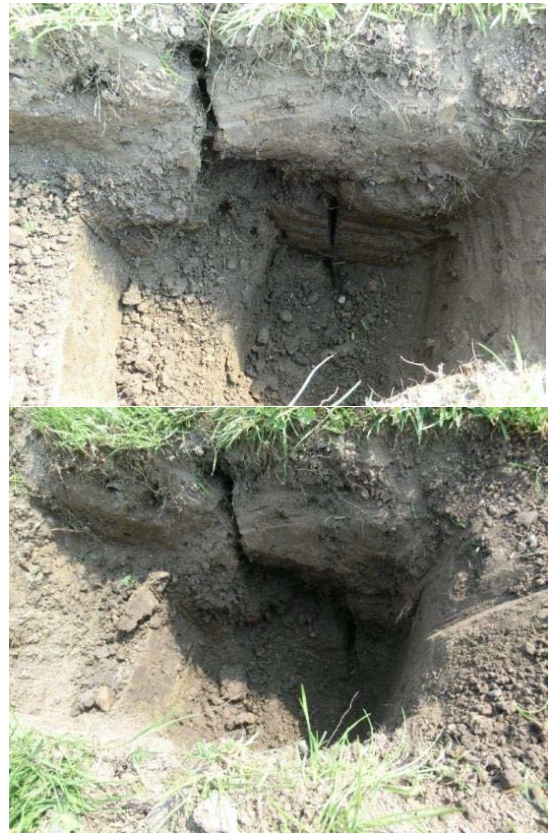
Horizontale verspringing hellingafwaarts (naar rechts) van de scheur beneden een diepte van 20 cm.
