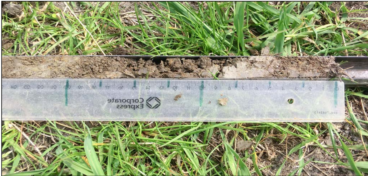
Foto 8 Bepaling van doorworteling, met rechts (zode) veel wortels, en links (circa 20 diepte) weinig wortels.
