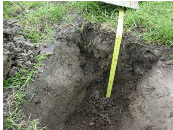
Rechts: scheur net rechts van maatband; bovenste 7-10 cm.
