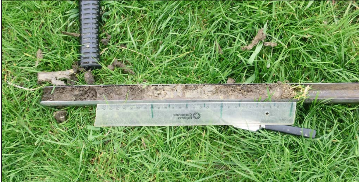
Foto 10 Bepaling van doorworteling, met rechts (zode) veel wortels, en links (circa 30 diepte) minder wortels, maar nog steeds aanwezig.
