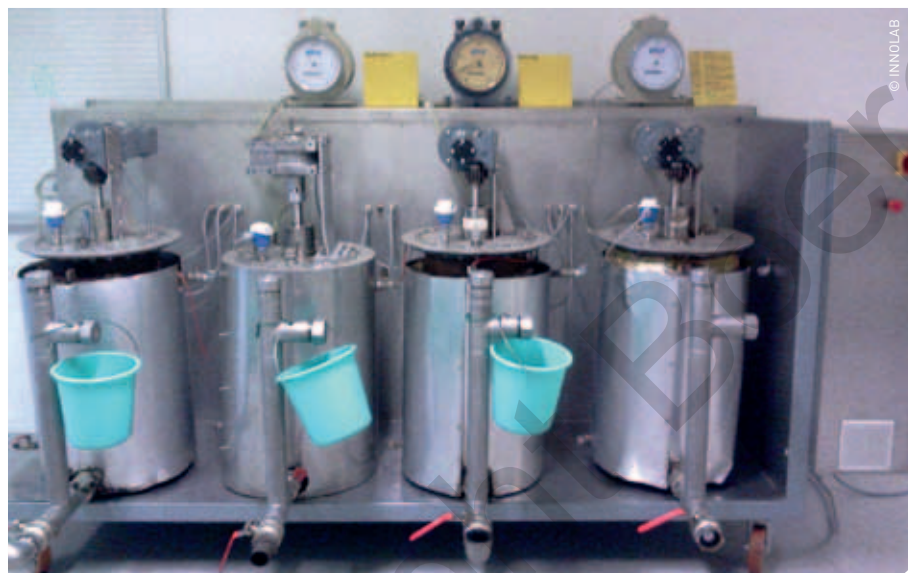
Laboratoriumopstelling met 2 semicontinue reactoren, een mesofiele en een thermofiele.
