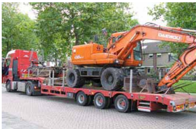
FIGUUR 6.3 AANVOER MOBIELE KRAAN MET KROOSBAK
