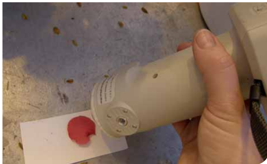
▲ De spectrofotometer zorgt voor de objectieve bepaling van de bloemkleur.
