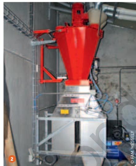
1 In de nieuwe vleesvarkensstal werd een PigScale-meeettoestel geïnstalleerd. 2 De WEDA-menger wordt aangestuurd door de droogvoedercomputer in de nieuwe vleesvarkensstal.
