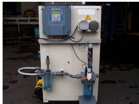
Figuur 4 Links de RQ flexmeter met meetstrookjes voor handmatige metingen en rechts de Prominent – Verder continue meet – en doseerapparatuur voor metingen van de concentratie van Jet 5.
