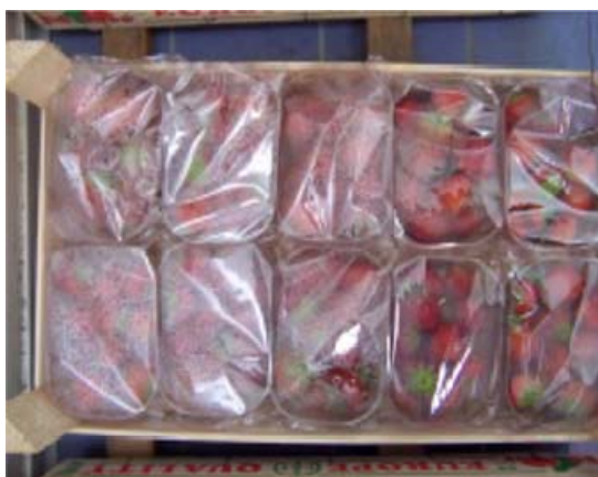
Foto 3. Condensvorming folie B (links) en folie A (rechts), 30 augustus 2004, proef 2.
