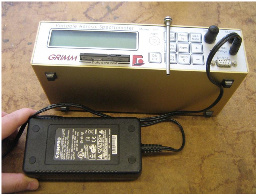
Figuur 3 Monsterapparatuur voor deeltjesgrootteverdeling, de stofspectrometer van Grimm.
