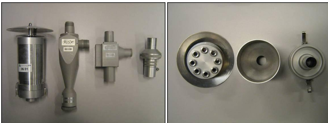
Figuur 2 Monsterapparatuur voor PM10 en PM2,5. Boven: de 'constant flow' monsternamepomp. Linksonder (van links naar rechts): inlaat, PM10 cycloon, PM2,5 cycloon en filterhouder. Rechtsonder: de constructie van de inlaat
