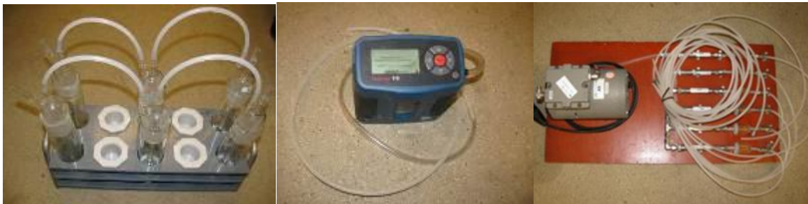
Figuur 5 Meetopstelling nat-chemische methode voor ammoniakemissiemetingen. Links: impingers. Midden: flowmeter. Rechts: pomp.
