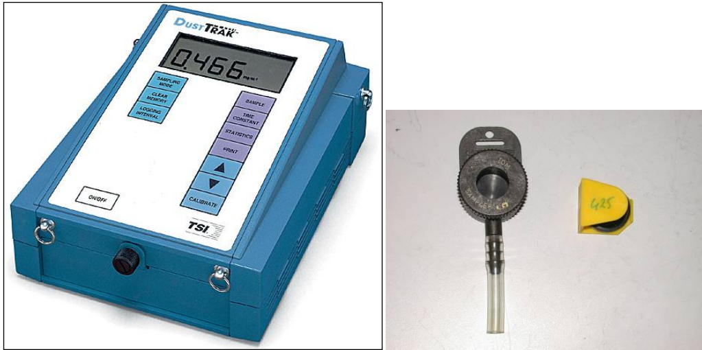
Figuur 1 Links: De DustTrak model 8520 voor optische en continue metingen van het verloop in PM10 concentratie. Rechts: Monsterapparatuur voor totaalstof, met links op de foto de IOM monsterekop met aanzuigleiding naar de pomp en rechts op de foto de filterhouder met bescherming voor transport.
