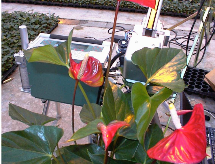
Fig. 7. Door de CO 2 concentratie in het meetcuvet te variëren werd het effect op de fotosynthese snelheid bepaald. De initiële startconcentratie was 600 ppm. In de meetcuvet werd de concentratie steeds gevarieerd. De lichtintensiteit werd constant gehouden op 250 μmol PAR. Metingen werden verricht aan cultivars 20, 10 en 18. Daarnaast werd voor de cultivar 18 een meting verricht aan een 72 plug stadium.
