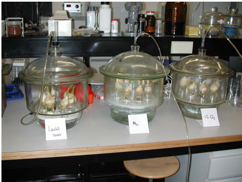
Foto 10. Opstelling: bewortelde bollen op water (met en zonder catechol) in exsiccatoren, waardoor standaardlucht (20% zuurstof), lucht met 1 % zuurstof en lucht met 0% zuurstof (100% stikstof) werd geleid.
