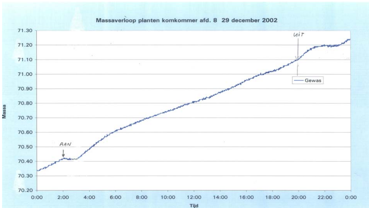
Figuur 2 Invloed van het in- en uitschakelen van de belichting op de gewasgroei zoals gemeten op 29 december 2002
