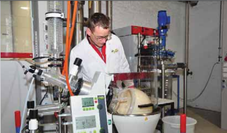
De filmverdamer. In dit apparaat worden uit de bietenpulp geïsoleerde vloeibare fracties onder vacuüm geconcentreerd tot een halfproductaat.
