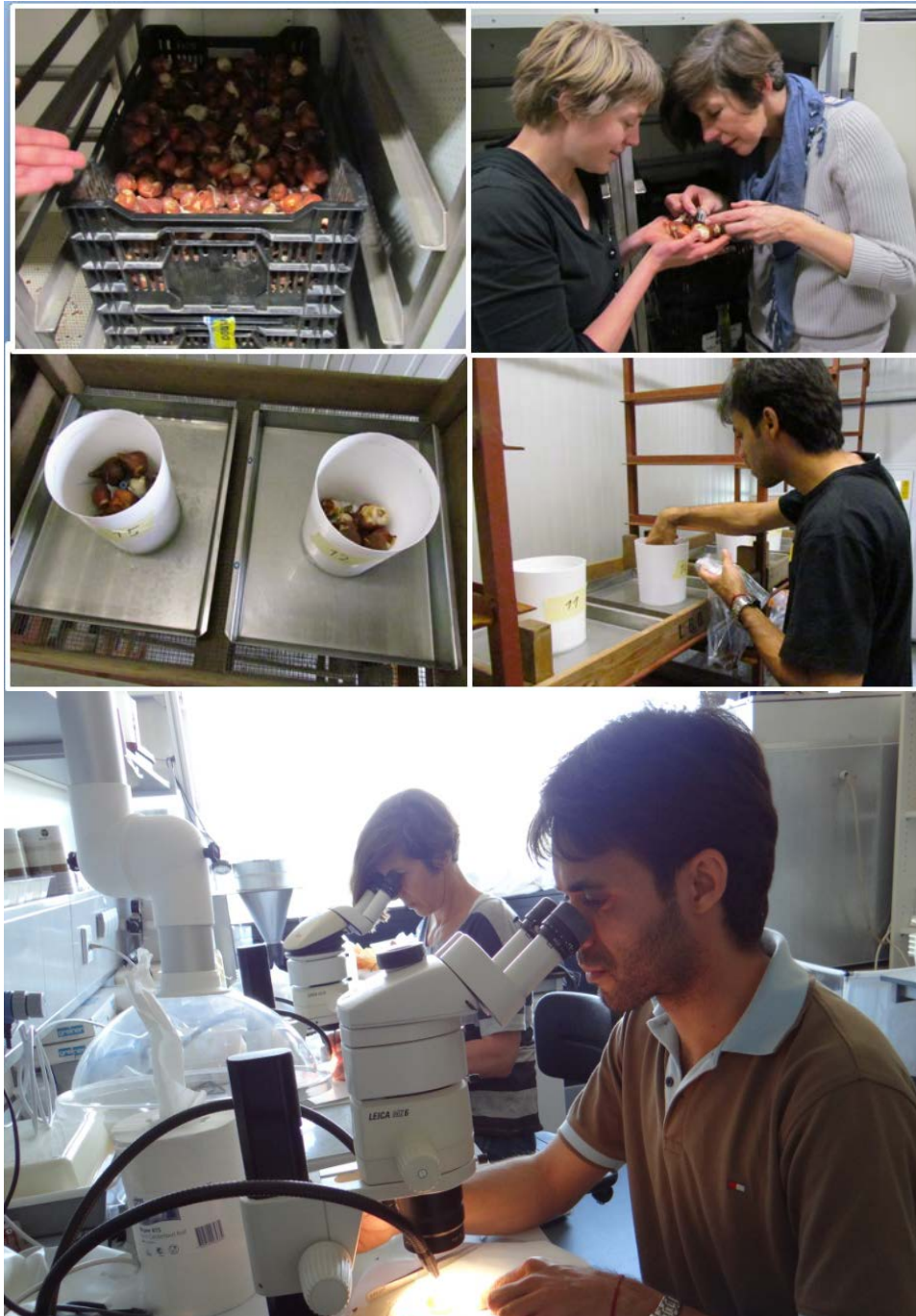
Figuur 3. De opzet van de proeven. Linksboven: besmetting van een schone partij tulpenbollen met galmijten via besmette knoflooktenen. Rechtsboven: Inspectie van de bollen. Links midden: twee herhalingen in de bewaring. Rechts midden: bemonstering van de bollen ter beoordeling. Onder: beoordeling van de bollen op de aanwezigheid van tulpengalmijten en roofmijten.
