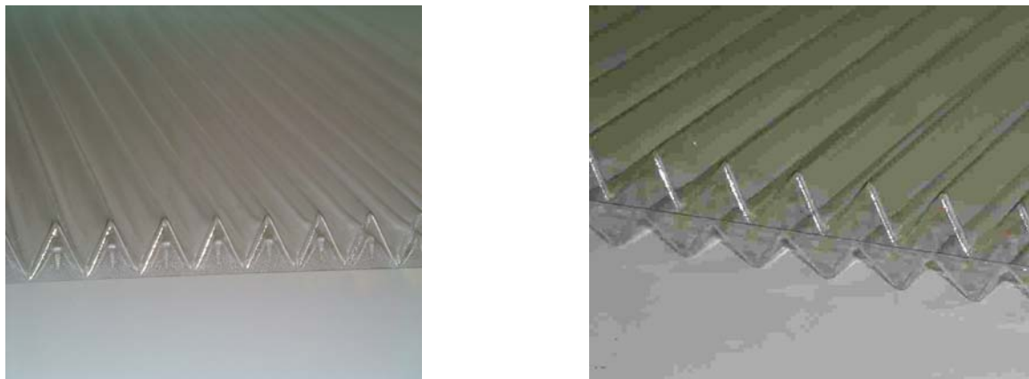
Fig. 3-8 Enkellaags- en dubbellaags zigzag-platen vervaardigd met vacuümvorm-technieken.
