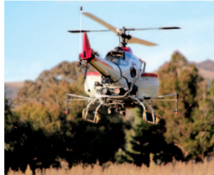
^ Vliegende robotspuit Deze uit de kluiten gewassen Yamaha RMAX is geschikt voor licht spuitwerk. De op afstand bestuurd heli heeft een motor van 250 cc, kan 28 kg tillen en wordt vooral gebruikt door rijsttelers in Japan.
