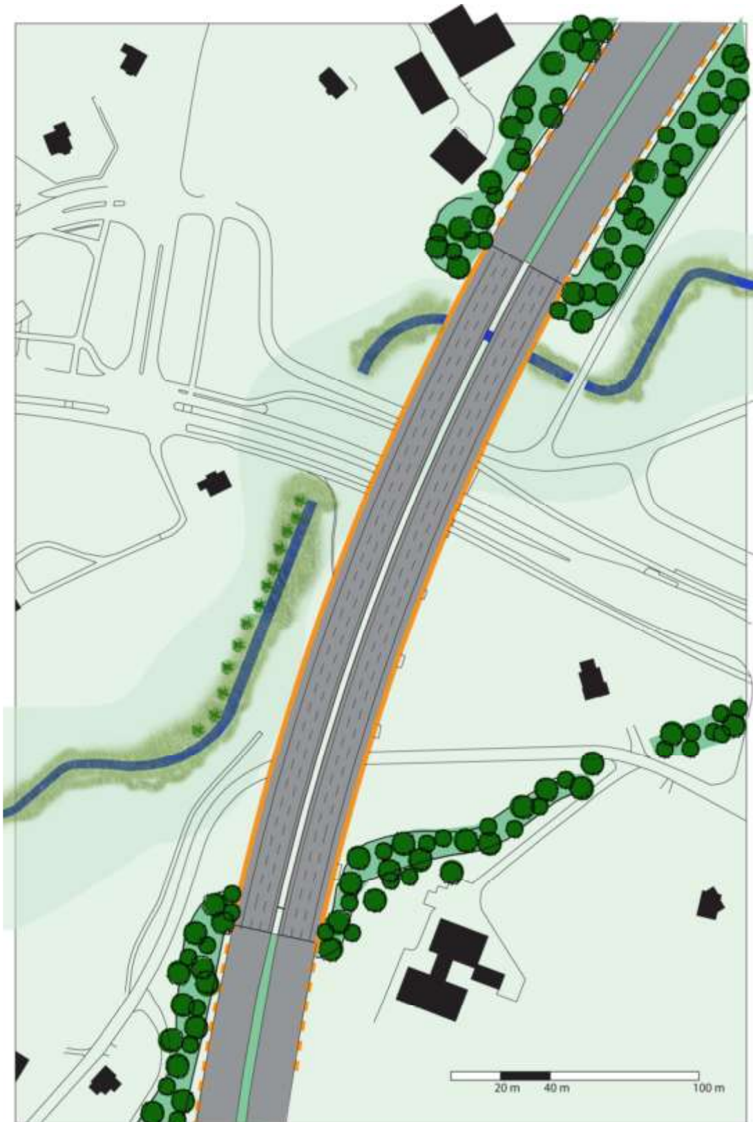
Figuur 18: Bovenaanzicht van het ontwerp voor het Beekdalviaduct. De oranje lijnen aan weerszijden van het viaduct en snelweg geven de geluidsbeperkende maatregelen weer; de onderbroken oranje lijn geeft weer dat het een transparant scherm (4 m hoog) betreft
