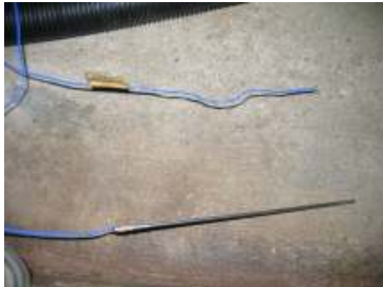
Thermokoppels: druppeltype voor droge en natte bol meting en staaftype voor dekaarde en composttemperatuur
