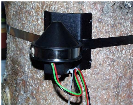
Figuur 2-4. De DR 22 Dendrometer (bron: http://www.emsbrno.cz ).
