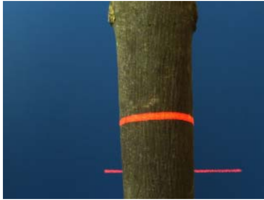
Figuur 3-6. Projectie van laserlijn op boomstam.
