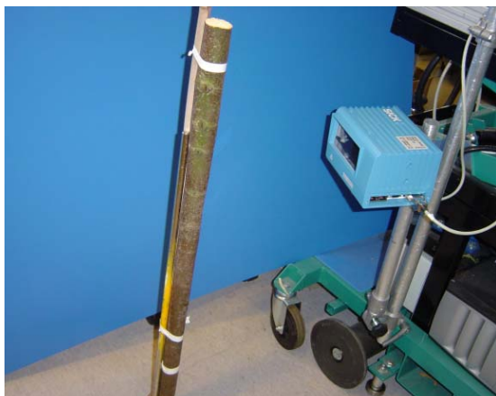
Figuur 3-2. Laseropstelling met boomstam.
