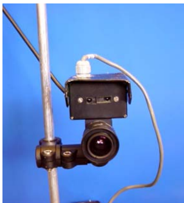
Figuur 3-7. Camera set-up met infrarood afstand sensor (links) en relatie objectafstand tot analoge uitgangsspanning van de GP2D12 (rechts).
