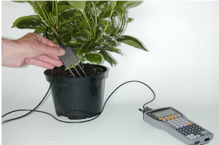
Foto 7. PPO. FD-sensor als meetinstrument voor volume % vocht, EC-waarde en temperatuur.
