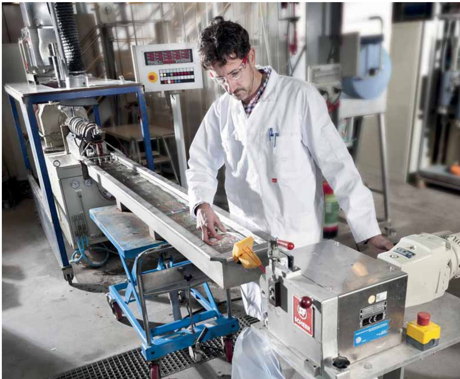
Richard op den Kamp van Biobased Products bij een extruder om bioplastics te maken.
