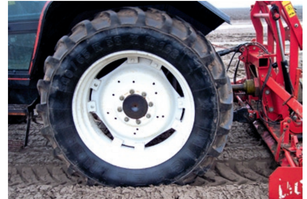
▲ Voor zo optimaal mogelijke groeiomstandigheden kun je bij een band kiezen tussen draagkracht, trekkracht, profilering en bandenspanning in relatie tot de bodemeigenschappen zoals grondsoort en bodemstructuur.
