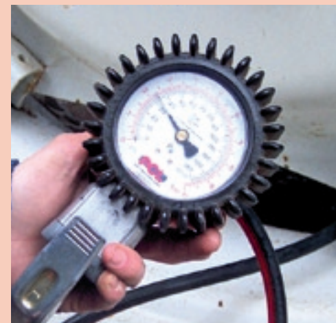
▲ Wat je ook moet weten is de bandenspanning. Op de foto lezen we op de spanningsmeter af dat er ruim 2 bar in de band zit. In de praktijk kan het voorkomen dat de meter door ouderdom of door slijtage niet meer de correcte stand weergeeft. In dat geval moet de meter geijkt worden om te bepalen of hij nog wel betrouwbaar is.
