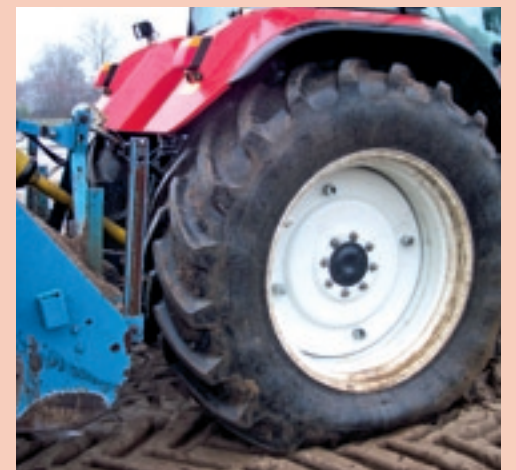
▲ Als de band op de goede spanning is gebracht, lijkt het wel of de band te zacht is. De trekkerbanden zijn evenwel gemaakt om met deze lage spanning te kunnen omgaan, waardoor het doel, overbrengen van trekkracht, goed tot zijn recht komt, zonder te veel schade in de bodem aan te richten.
