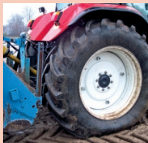
▲ Als de band op de goede spanning is gebracht, lijkt het wel of de band te zacht is. De trekkerbanden zijn evenwel gemaakt om met deze lage spanning te kunnen omgaan, waardoor het doel, overbrengen van trekkracht, goed tot zijn recht komt, zonder te veel schade in de bodem aan te richten.
