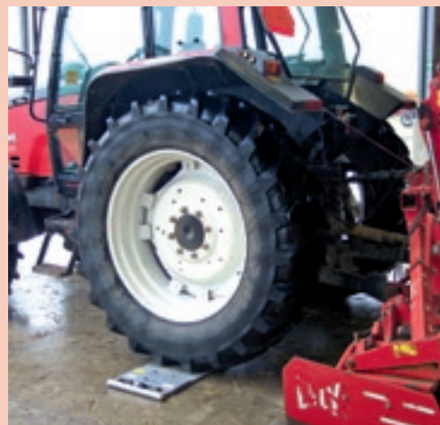
▲ Met een weegplaat onder de achterband van de trekker kun je precies meten hoe groot de last is die deze band moet dragen. Vanzelfsprekend heeft niet iedereen zo'n hulpmiddel. In dat geval moet je het gewicht van trekker en werktuig schatten en dan voor de verschillende banden de last bepalen.
