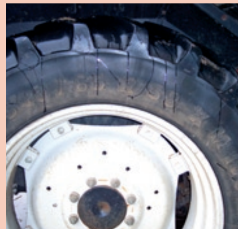
▲ Vervolgens moet je de informatie op de band aflezen die je nodig hebt om de bandenspanning te bepalen. Elk merk heeft zo zijn eigen wijze om de karakteristieken van de band weer te geven. Soms is het flink zoeken, zeker als de band door het werk vervuild is. In dit geval gaat het om een band met de codering 540/65 R38 XM 108.
