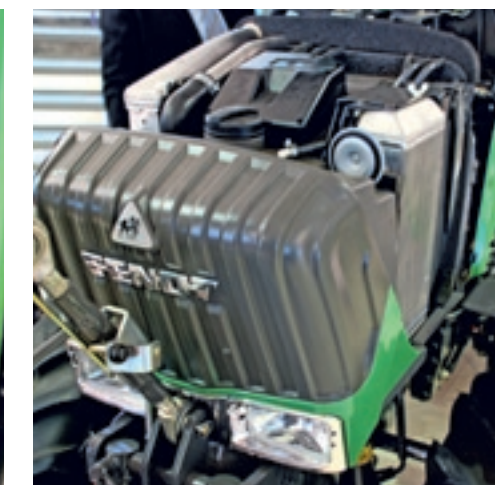
▲ De neus is omgetoverd tot dieseltank, de koelers zitten aan beide zijanten.
