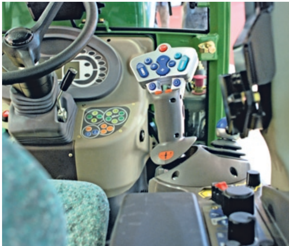
▲ Optioneel is deze multifunctionele joystick uit de Fendt 900-serie te krijgen waarmee je naast de transmissie ook vier dubbelwerkende ventielen, de hef, aftakas en vooringestelde functies kunt bedienen.
