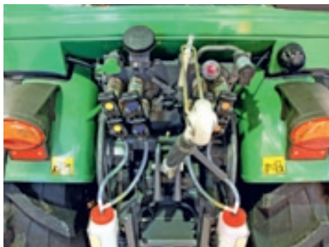
▲ Maximaal zijn er zes dubbelwerkende ventielen aan zowel de achter- als zijkant.
