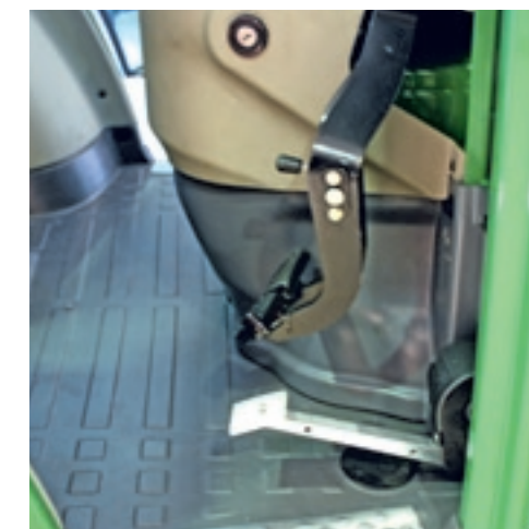
▲ De cabine heeft nu een vlakke vloer. Met het witte gaspedaal kun je ook rijden zonder de joystick te gebruiken.
