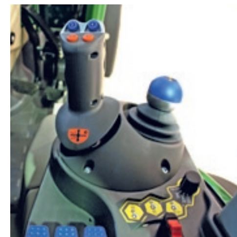
▲ Met de standaardjoystick bedien je de Vario. Versnellen en langzamer rijden is een kwestie van vooruit of achteruit duwen.
