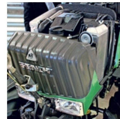
▲ De neus is omgetoverd tot dieseltank, de koelers zitten aan beide zijkanten.
