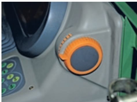
▲ De grote oranje knop om het toerental vast te zetten, zit aan de zijkant van de stuurconsole.
